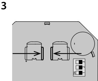
Před uvedením do provozu otevřete pomocí šroubováku kryt detektoru (obr. 1). Nastavovací prvky jsou umístěny uvnitř detektoru. Odstraňte izolační fólii, překontrolujte správné umístění baterie.
